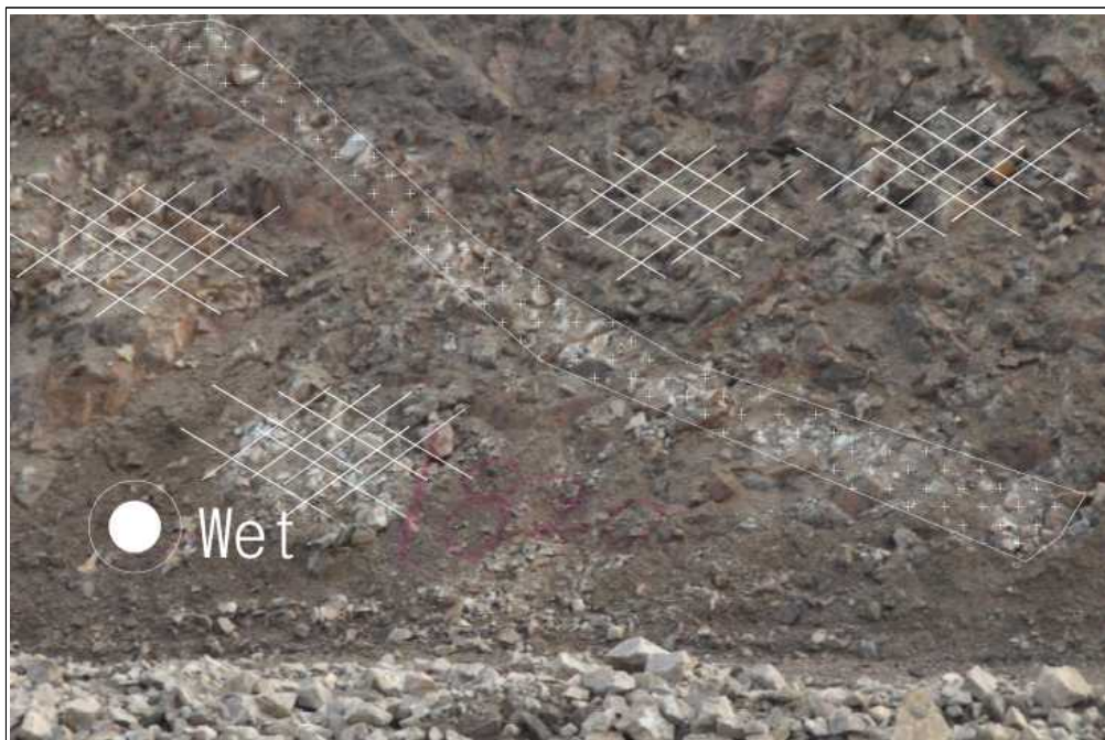
【그림 32】 C 영역 상세사진(세편화된 암석 및 산성 암맥 관입)
