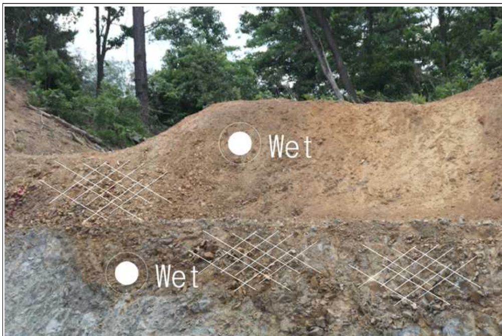
【그림 44】 F 영역 상세사진 (지하수 유출 및 세편화된 암석)
